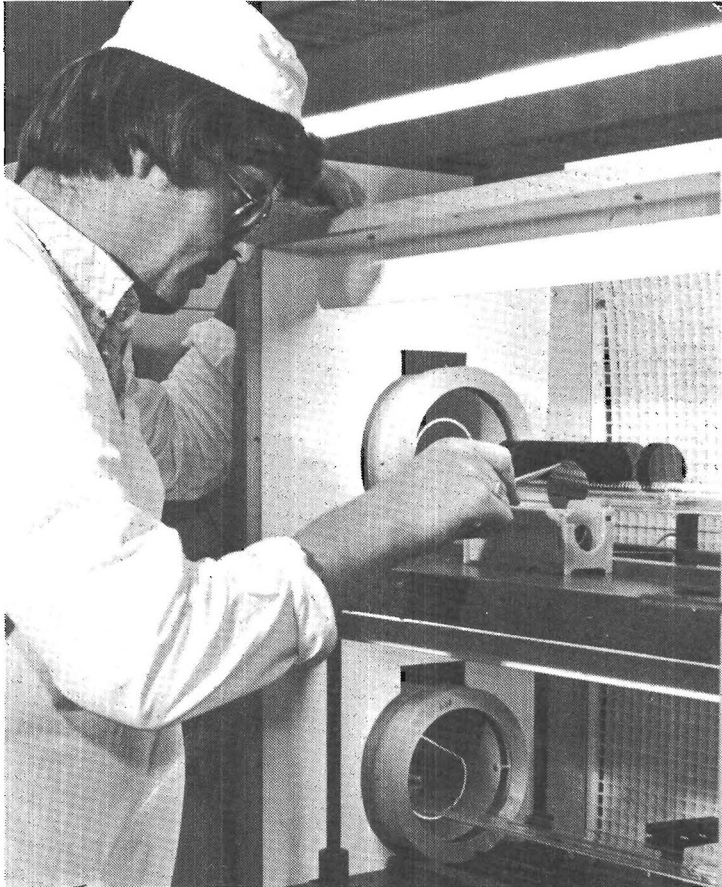
Chips zijn flinterdunne plakjes silicium, waarop een IC is aangebracht. Voor ovenbewerkingen worden de plakken met een pincet uit de badge gehaald en in de slede gezet.
