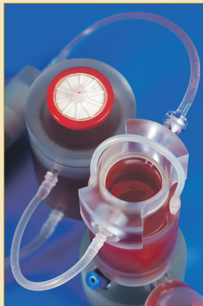
Een bioreactor waarin lichaamseigen hartkleppen worden gekweekt. Foto: Bart van Overbeeke
